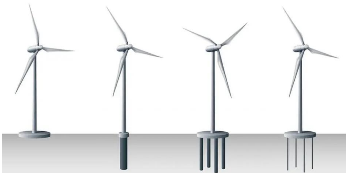
Joonis 4. Tuulikute vundamentide tüübid 5 .
